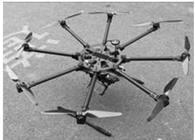
图 3 YS-1200 多旋翼双镜头倾斜摄影无人机
